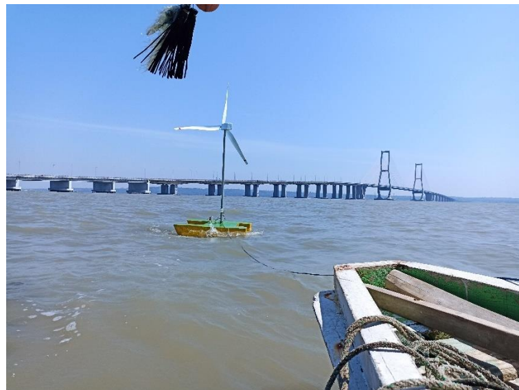
Gambar 4. Pengujian katamaran wind turbin di Pantai Timur Surabaya
