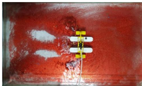
Gambar 10. Hasil Visualisasi pada Pengujian Variasi 55° RPM 108
