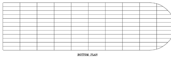
Gambar 3.4 Lajur Pengelasan Bottom Plate
