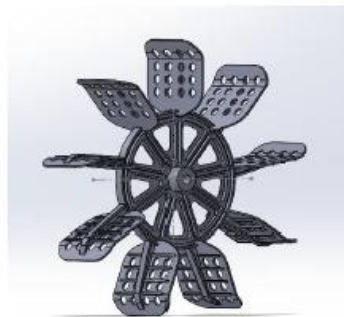
Gambar 2. Desain Kincir Paddle Lengkung Radius
