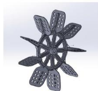
Gambar 3. Desain Kincir Paddle Lurus Radius
